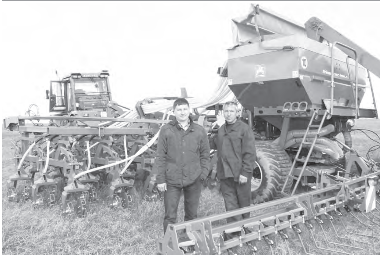
Александр Семенов, главный инженер, и Юрий Григорьев, механизатор ООО «Совхоз «Береговой», у нового посевного комплекса. Это трактор К-744 и итальянская стерневая сеялка с несколько игровым названием «Амазонка», длина захвата которой 9 метров — она одновременно обрабатывает почву, вносит удобрение, высевает зерно и еще прикапывает высеянные участки земли
